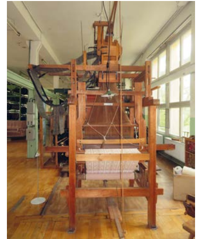
Handwebstuhl mit Jacquardsteuerung der Firma W. Dachsel & Th. Mühlmann, vorm. August Fröbel Chemnitz, etwa um 1935
